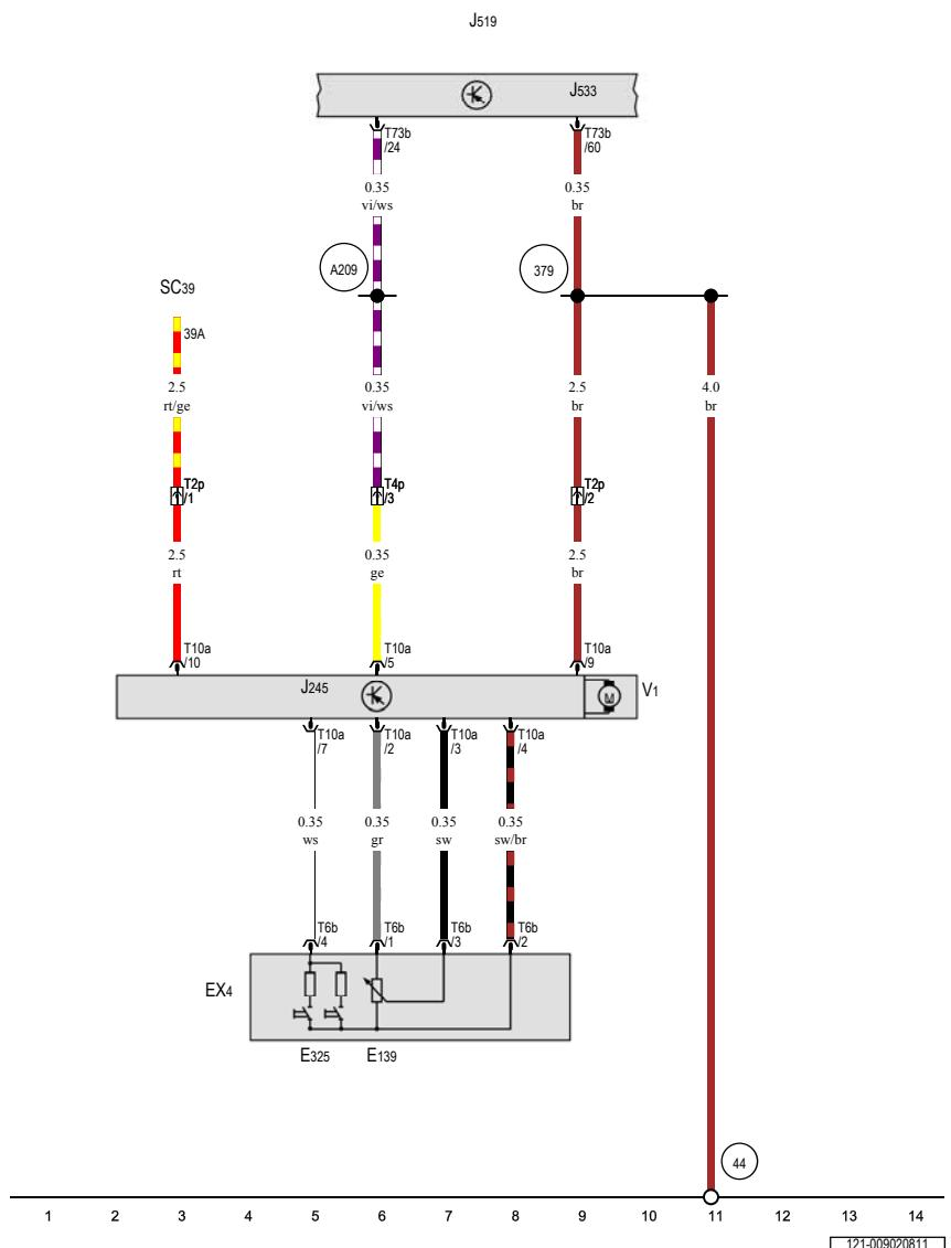
滑动调节, 滑动天窗控制单元, 车载电网控制单元, 滑动天窗电机
